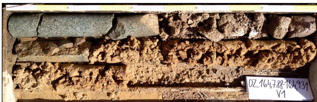
Obr. č. 1 - diagnostický vrt V1
